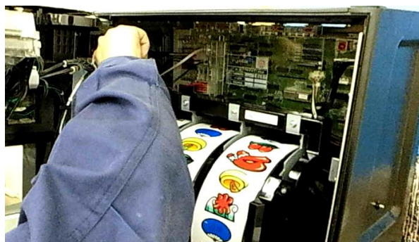
⑩プラスドライバーで取り付けビスを外します。
