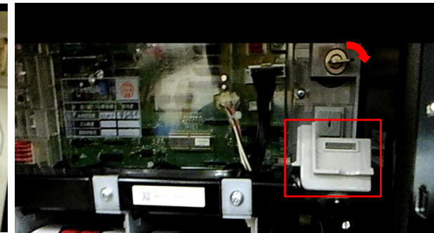
③ホルダーロック(基板キー)を右に回し、主基板ケースホルダーを外す。
