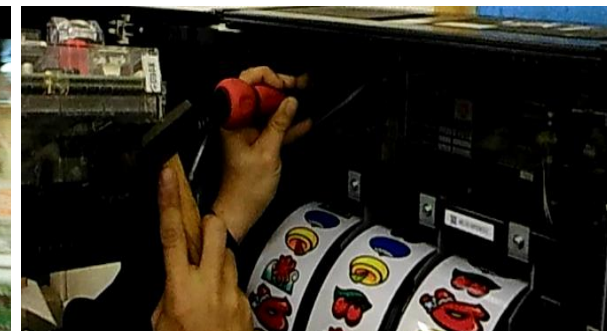
⑧プラスドライバーとハンマーでカシメを破ります。
