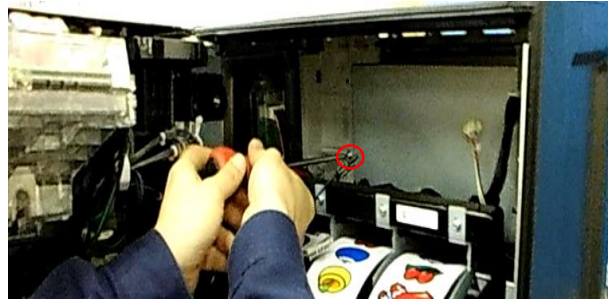
24.固定ベース(左側)の下側のビスを外します。
